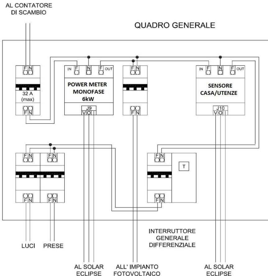
Figura 8 – Schema cablaggio quadro elettrico
