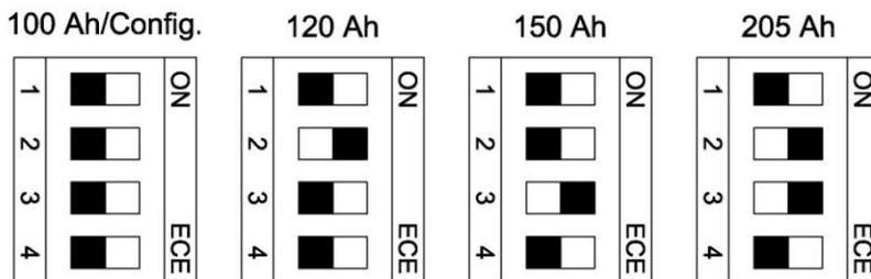
**Figura 11 – Configurazione batterie tramite *dip-switch***
