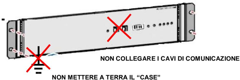
Figura 2 – Cablaggi batterie Pylon
