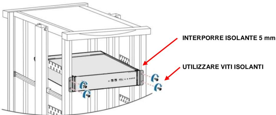
Figura 1 – Fissaggio batterie Pylon
